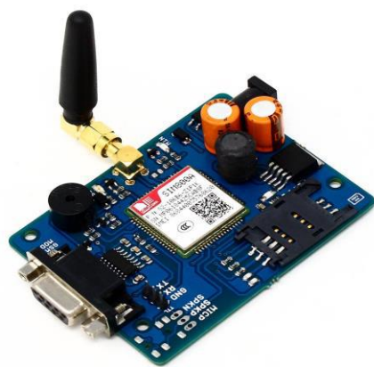
Fig.7: SIM 800A GSM Module
