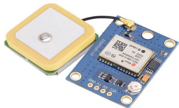
Fig.5: NEO-6M GPS Module
