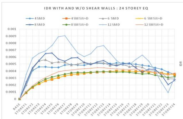
Fig. 15: Inter storey drift ratio : 24 storey (EQ)
